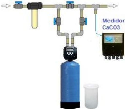
**MDK V1.3** analiza en continuo la dureza total del agua producida por su descalcificador. El intervalo de medición comprende desde un mínimo de 5 minutos hasta un máximo de 24 horas, con la posibilidad de programar días y franja horaria de medición
